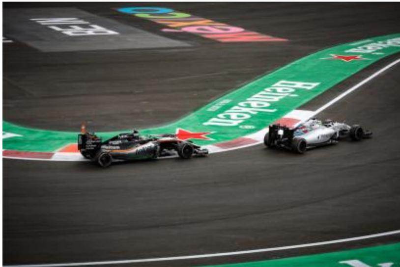
Para esta temporada, los alerones delanteros crecieron de 1,650 metros a 1,800; en cuanto al alerón trasero, disminuyó la altura y se incrementó la anchura para darle al auto un nivel superior de carga aerodinámica.
